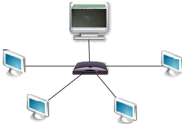
Figura 6. Red local de computadoras. Hasta 10 equipos conectados en una red local pueden utilizar un mismo sistema Iglesia HOY instalado en un servidor
